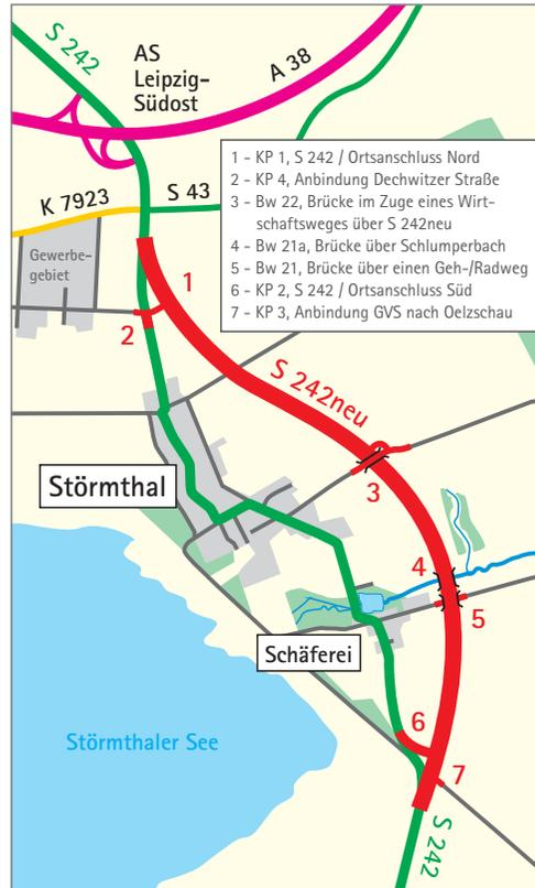
Die Länge der Baustrecke beträgt 3.335 m. Hinzu kommen Anschlüsse von untergeordneten Straßen mit einer Gesamtbaulänge von ca. 600 m.
