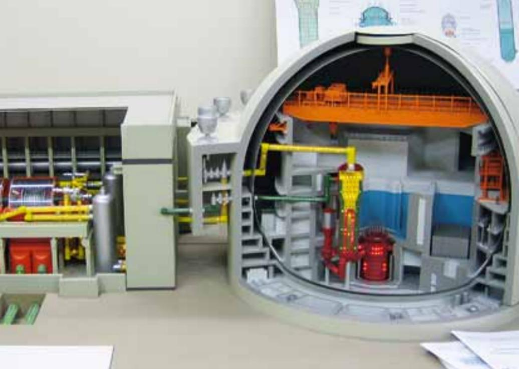
Modell eines Druckwasserreaktors
