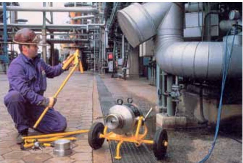
Untersuchungen von Rohren mittels radioaktiver Strahlung
