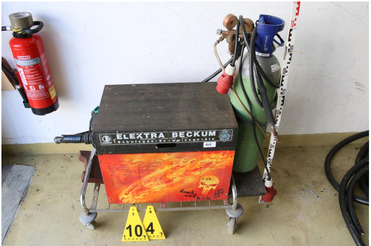
Bildbeschreibung: Nr.104) - Schutzgas Schweißgerät MIG MAG, Elektro Beckum Fabr. EB 145 mit Gasflasche und Zubehörteilen, (D0FKHA9) / Gasflasche - I5110S13R0A001 , 10kg, M56704107 Air Liquide UN 1013 Kohlendioxid
