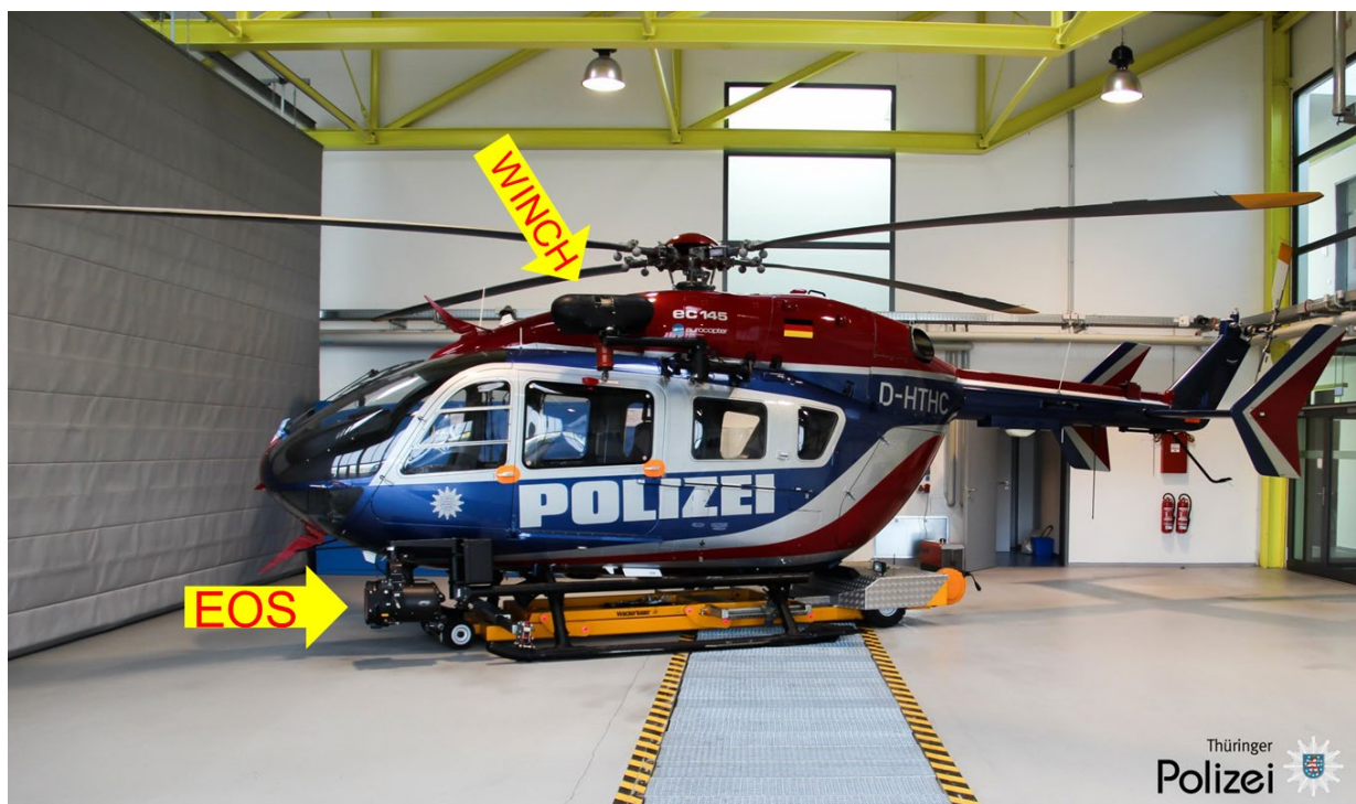
Bild 25: Polizeihubschrauber der Landespolizei Thüringen mit EOS (Elektro-optische Systeme) und Winde (engl.: Winch) (Polizei Thüringen, 2020 [34]).
