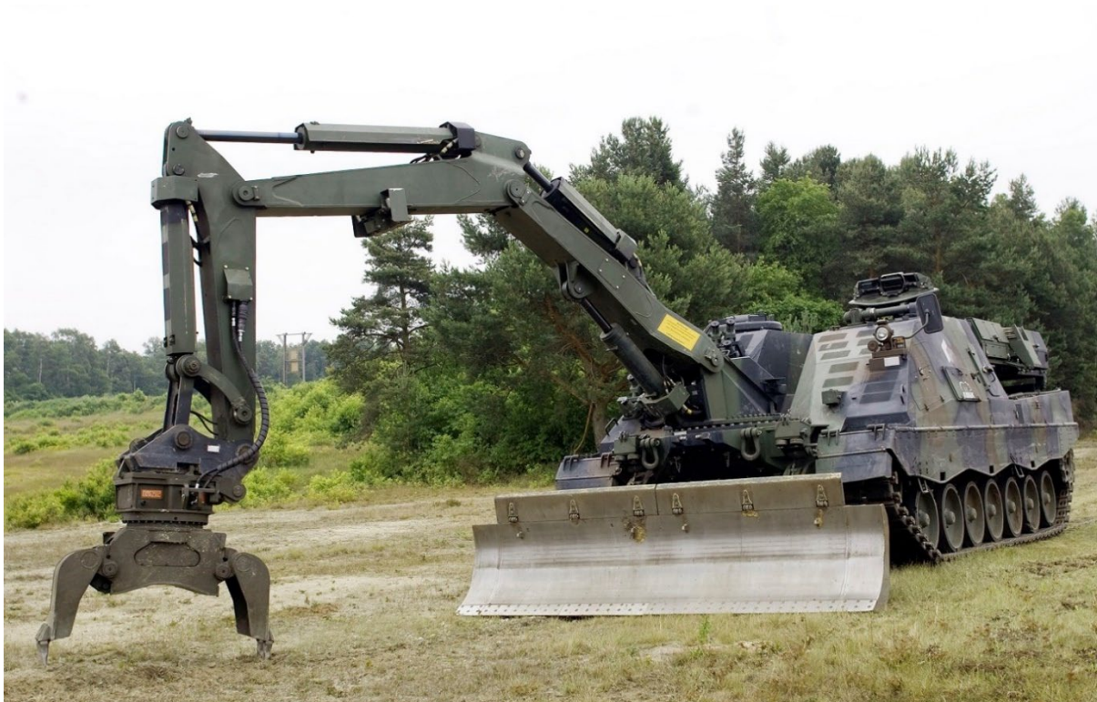
Bild 9: Pionierpanzer Kodiak (PiPz3) der Bundeswehr als Nachfolger des Pionierpanzers Dachs. Knickarmbagger, Räumschild und Doppelwindenanlage (Zugkraft bis 62 t) eignen sich hervorragend zur schnellen Anlage von Schneisen, Schutzzonen und Ankerpunkten in Waldgebieten. Der hohe ballistische Schutz sowie ein integrierter Minenschutz erlauben den Einsatz des Fahrzeuges auch in Kampfmittelverdachtsflächen. Das Gesamtsystem ist fernsteuerbar (Rheinmetall Landsysteme GmbH, 2021[10]).
