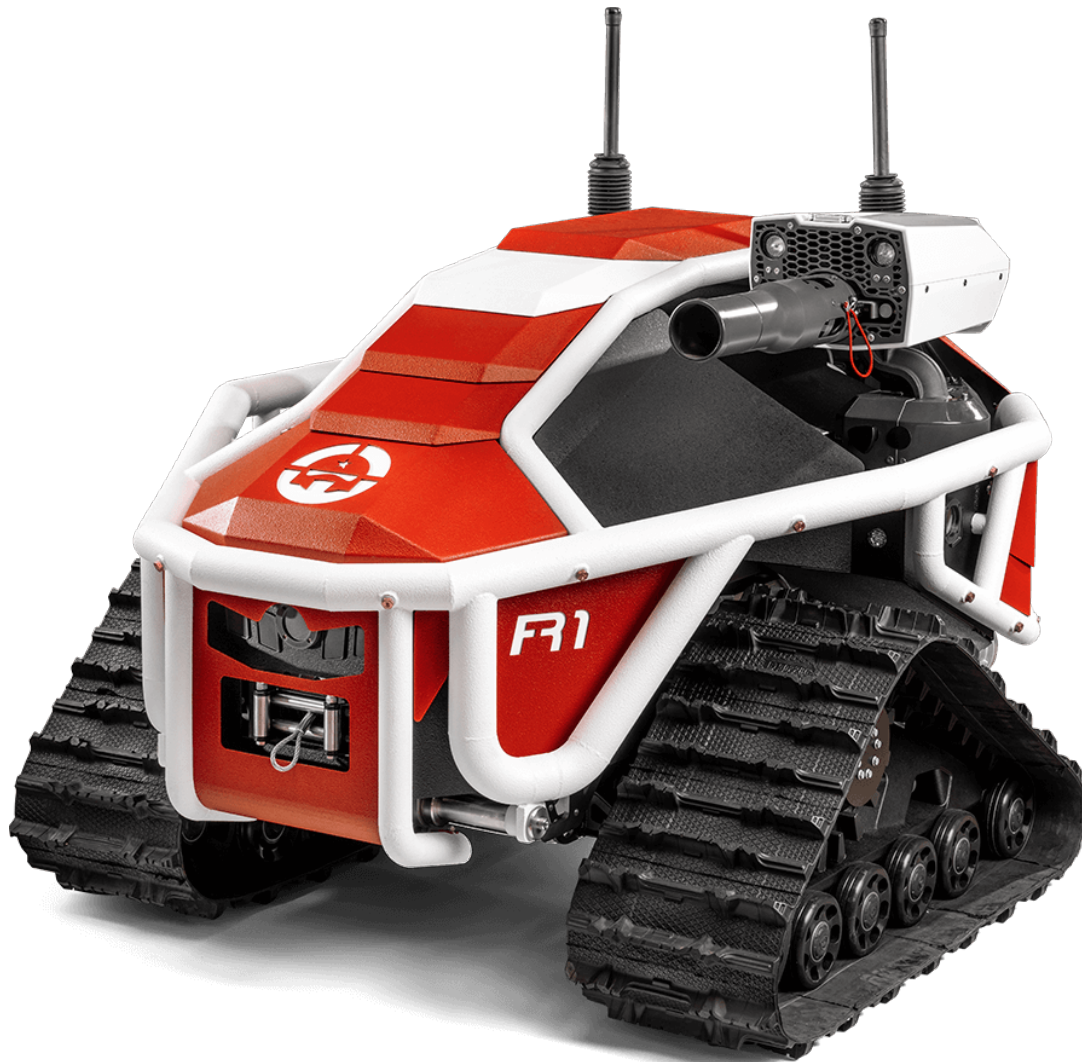
Bild 67: Autonomes Waldbrandeinsatzfahrzeug des Typs Alpha Wolf R1 (in der Serienmodellausführung) der Fa. Alpha Robotics (Alpha Robotics, 2021 [62]). Die Stabantennen stellen die fernmeldetechnische Verbindung zu einem entfernt sich befindenden Piloten her. Der Rammschutz beinhaltet Selbstschutzsprühdüsen und der Kettenantrieb lässt das Fahrzeug auch in unwegsamen Geländen vorankommen. Die auf dem Fahrzeug montierte Wasserabgabeeinrichtung entspricht einem Monitor, so wie dieser auch auf Tanklöschfahrzeugen zur Verwendung kommt. Das Fahrzeug wird am Heck derzeit noch mittels einer B-Schlauchleitung mit Wasser oder Wasser-Schaummittel-Gemisch bedrückt und hat damit eine maximale Eindringtiefe von ca. 200 m in Abhängigkeit der Geländebeschaffenheit.
